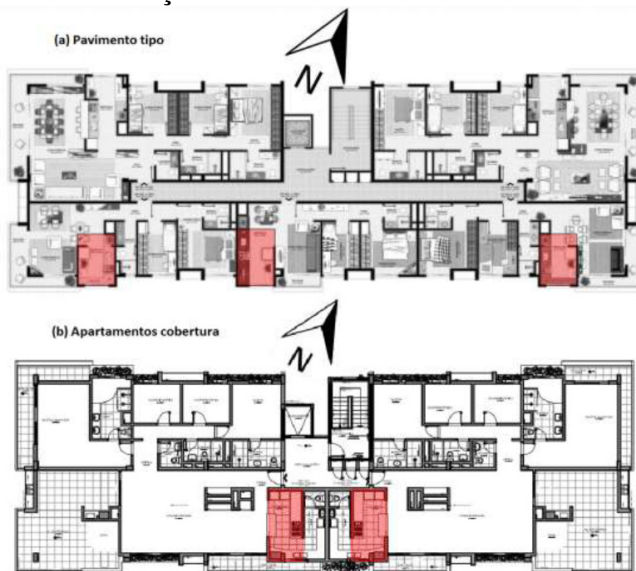
Figura 1: Planta do pavimento tipo e cobertura com marcação das áreas molhadas – cozinha e área de serviço
