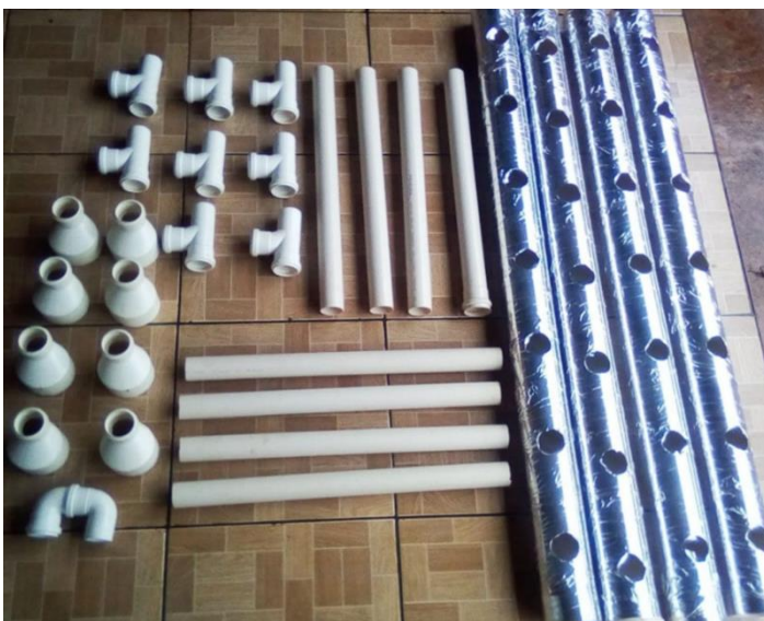
Figura 4: Materiais utilizados para montagem do sistema hidropônico NFT caseiro.
