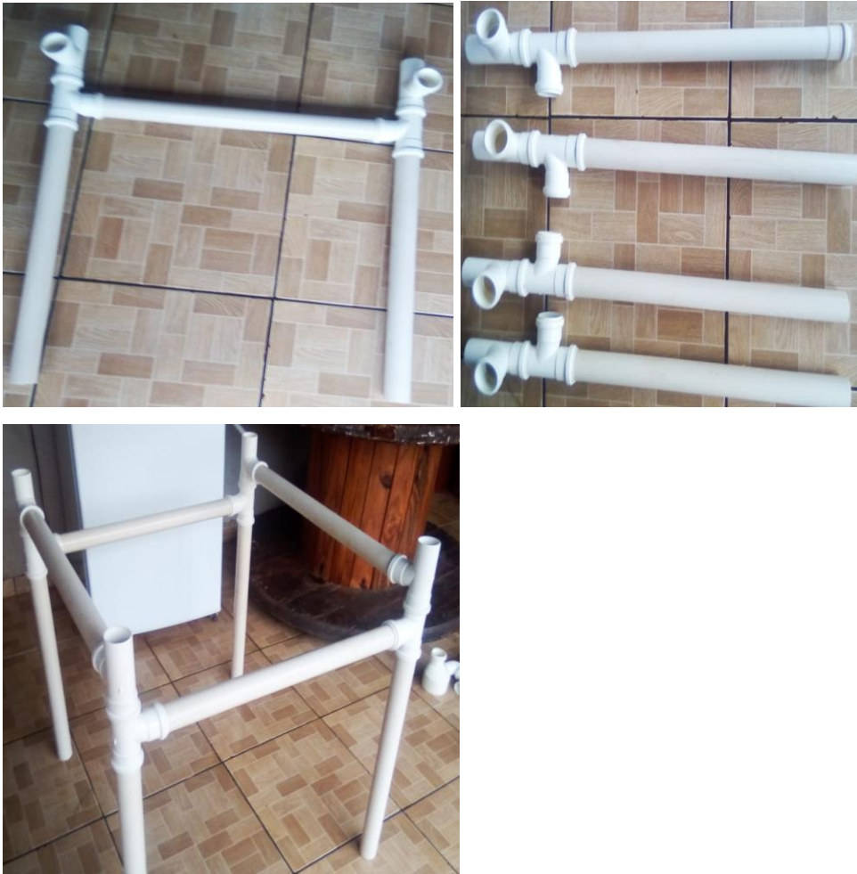
Figura 4: Materiais utilizados para montagem do sistema hidropônico NFT caseiro.
