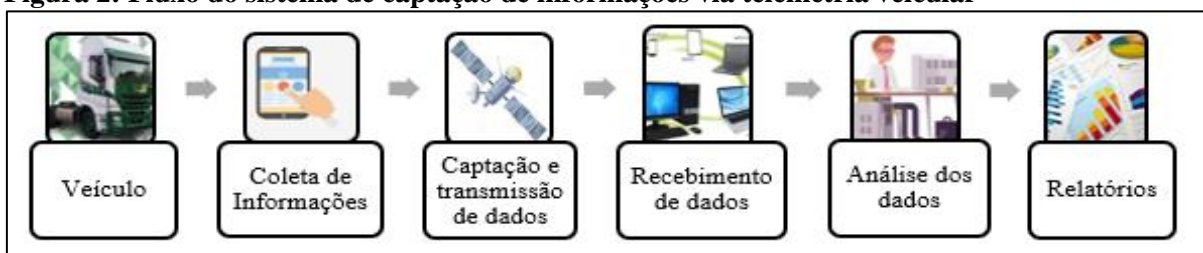
Figura 2: Fluxo do sistema de captação de informações via telemetria veicular
