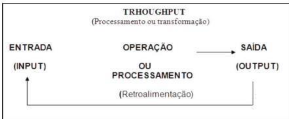
Figura 2: Sistema de produção: entradas (inputs), transformação (throughput), saídas (outputs) e retroalimentação (feedback)
