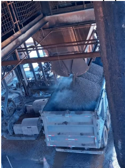
Figura 5: Torta de filtro sendo depositada no caminhão após passagem pelo filtro-prensa
