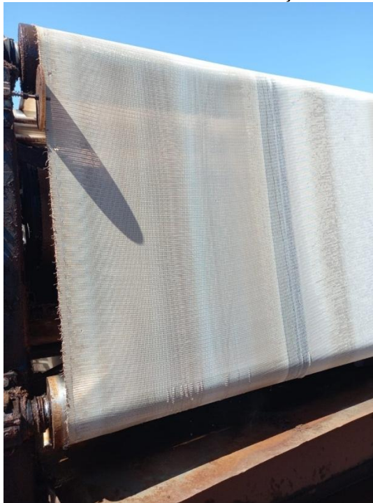
Figura 3: Telas filtrantes utilizadas na retenção de sólidos do caldo
