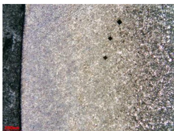
Figura 23: Micrografia da região mais externa até o núcleo. Aumento de 50x.
