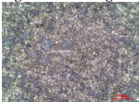
Figura 20: Micrografia da região do núcleo da amostra. Aumento 100x.
