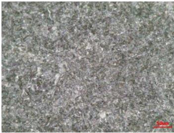
Figura 17: Micrografia da região do núcleo da amostra. Aumento de 200x.
