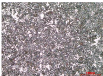
Figura 24: Micrografia da região do núcleo. Aumento de 200x.
