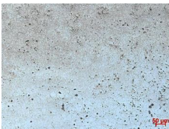
Figura 16: Distribuição do tamanho de grão em matriz austenítica. Os pontos pretos são a carepa formada devido ao processo de aquecimento e resfriamento brusco da amostra. Ampliação: 100x.
