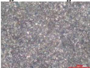
Figura 21: Micrografia da região da camada efetiva cementada. Aumento 1000x.
