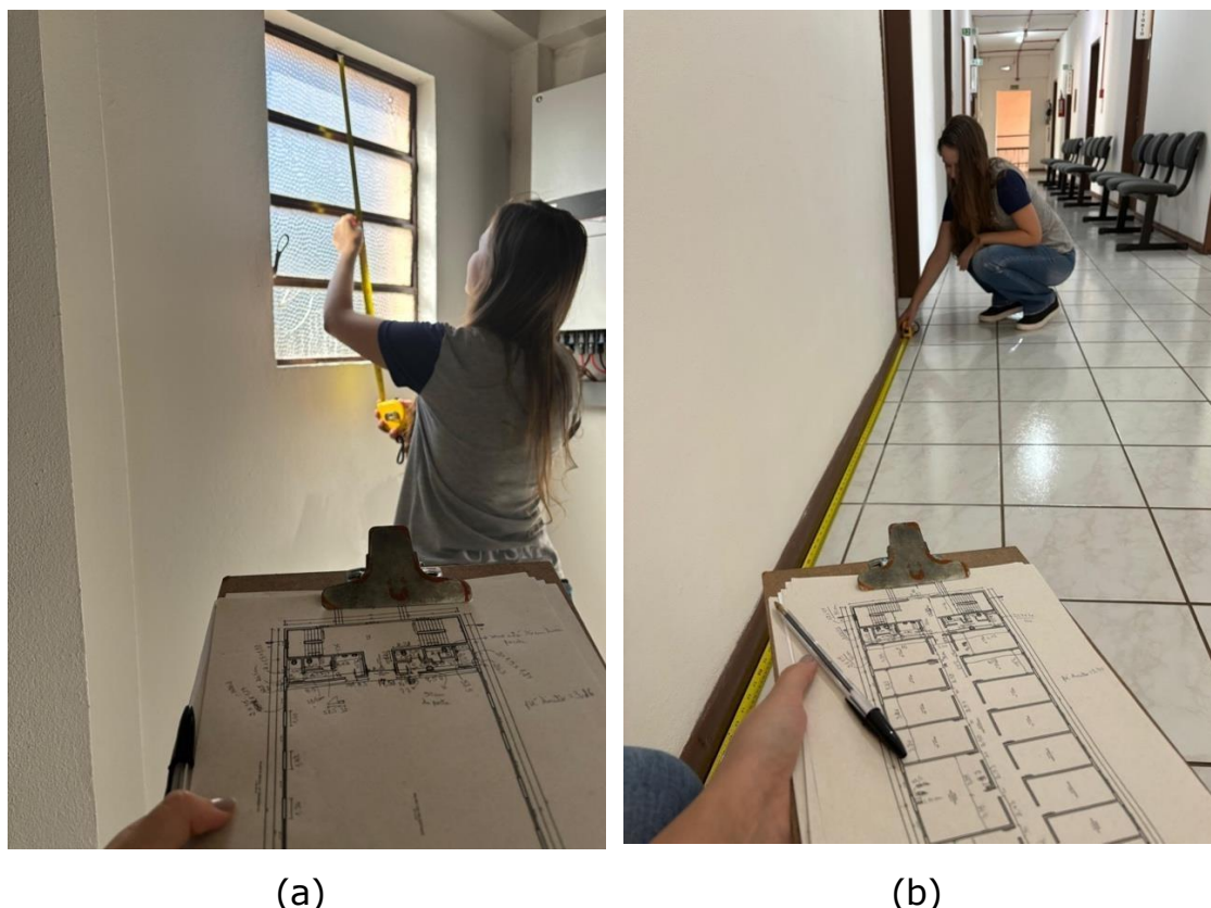
Figura 8: (a) Medição da altura da janela basculante no pavilhão de atendimentos espíritas; (b) Conferência de medidas entre esquadrias.
