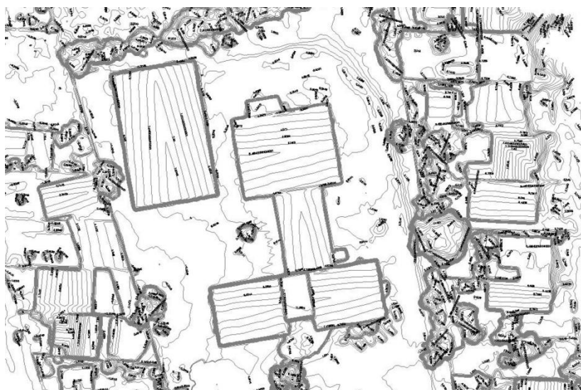
Figura 14. Planta de curvas de níveis obtidas com auxílio do drone Fonte. Acervo Grupo PET Engenharia Civil da UFSM (2024)
