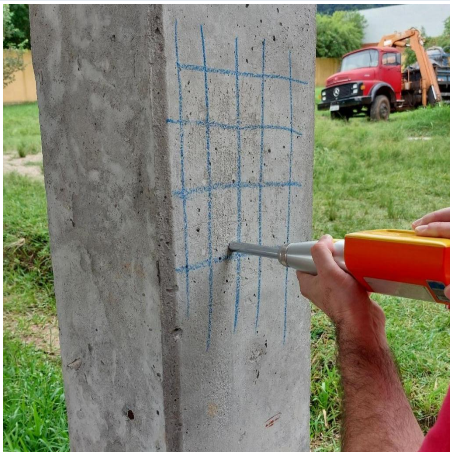
Figura 11. Realização do teste de dureza superficial do concreto
