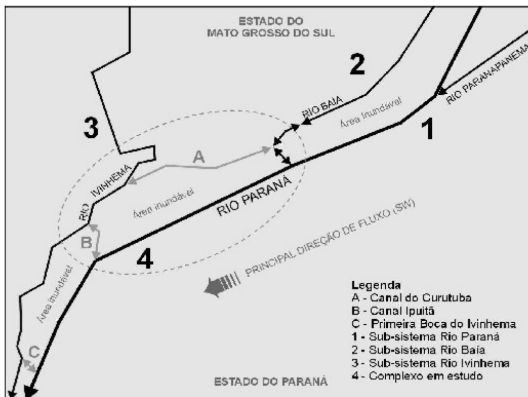
Figura 7. Sentidos de fluxo observados nos canais do sistema de inundação do Alto Rio Paraná. Adaptado de Comunello (2001).
