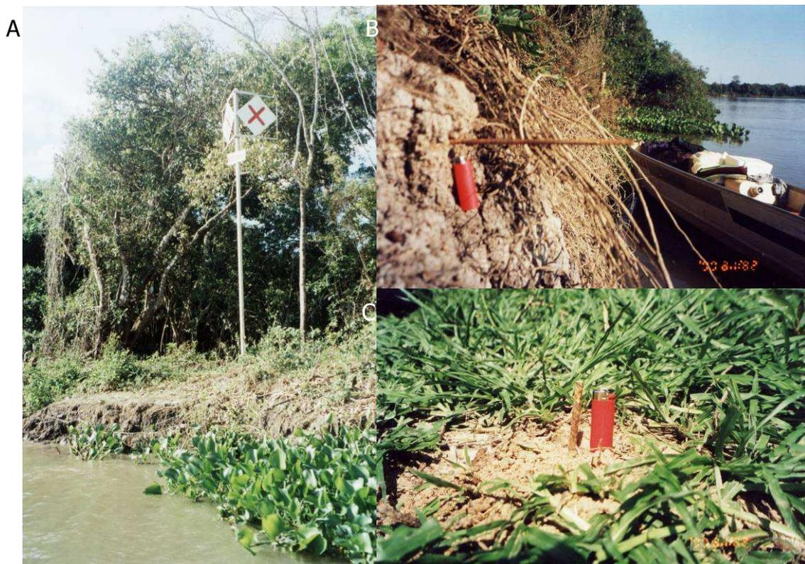
Figura 2 – Visualização dos procedimentos realizados para monitorar a erosão nas margens (A), mastro da Marinha (B), estaca e (C) pino de erosão.
