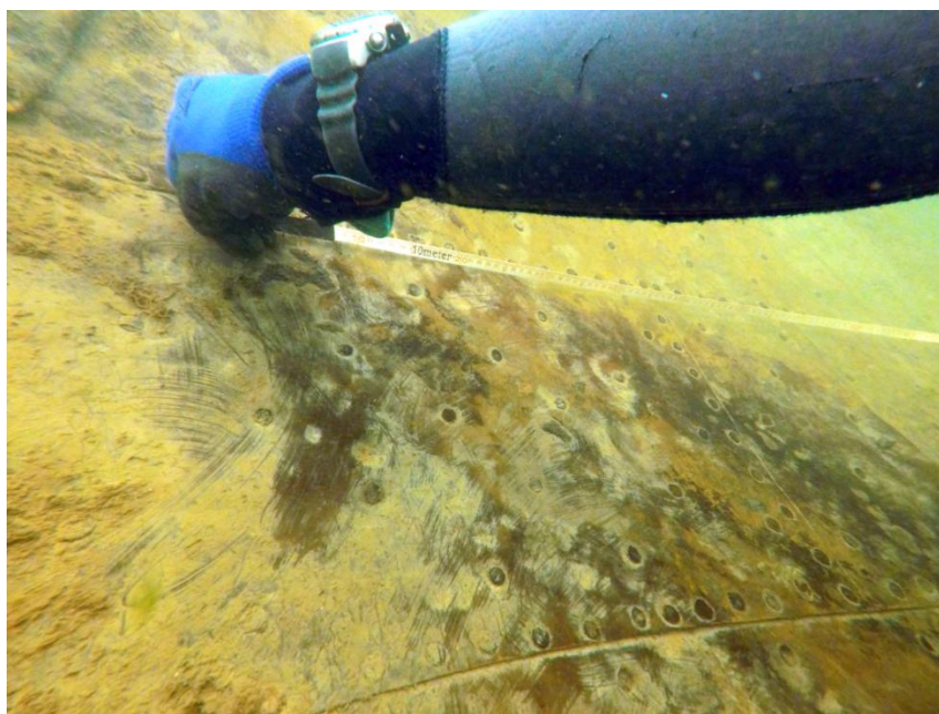
Figura 1: Parte do costado da embarcação do sítio arqueológico Naufrágio de Neópolis sendo medido pelo arqueólogo. É possível ver o revestimento anti-fouling com chapas de cobre. Fonte: Autores, 2023.
