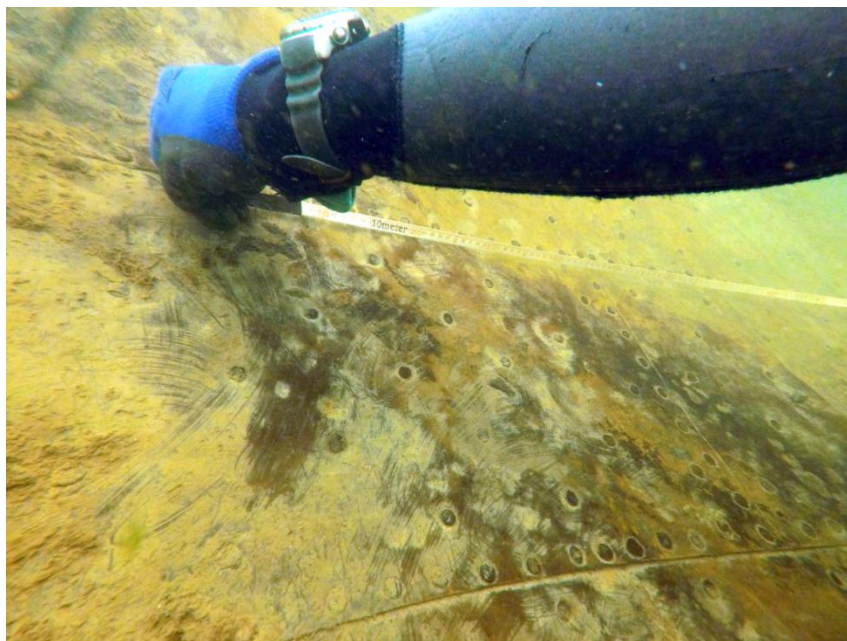
Figura 1: Parte do costado da embarcação do sítio arqueológico Naufrágio de Neópolis sendo medido pelo arqueólogo. É possível ver o revestimento anti-fouling com chapas de cobre .
