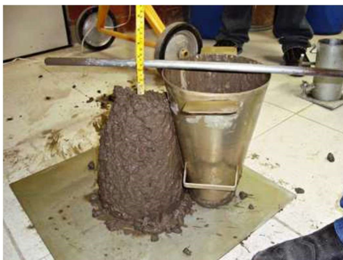
Figura 5 - Slump test ou abatimento
