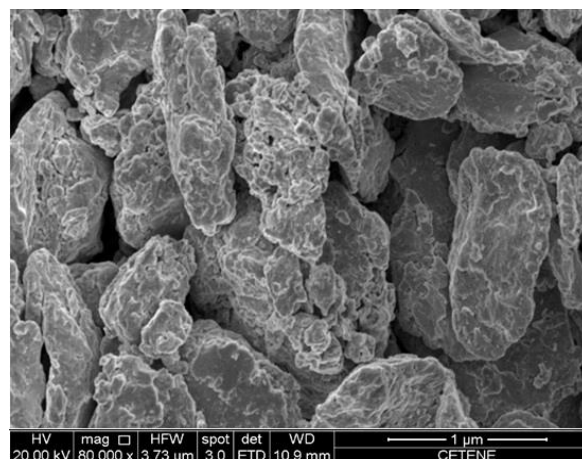
Figura 5. Imagem do MEV do pó \text{Co}_{72}\text{Nb}_{24}\text{B}_4 em forma aglomerados.
