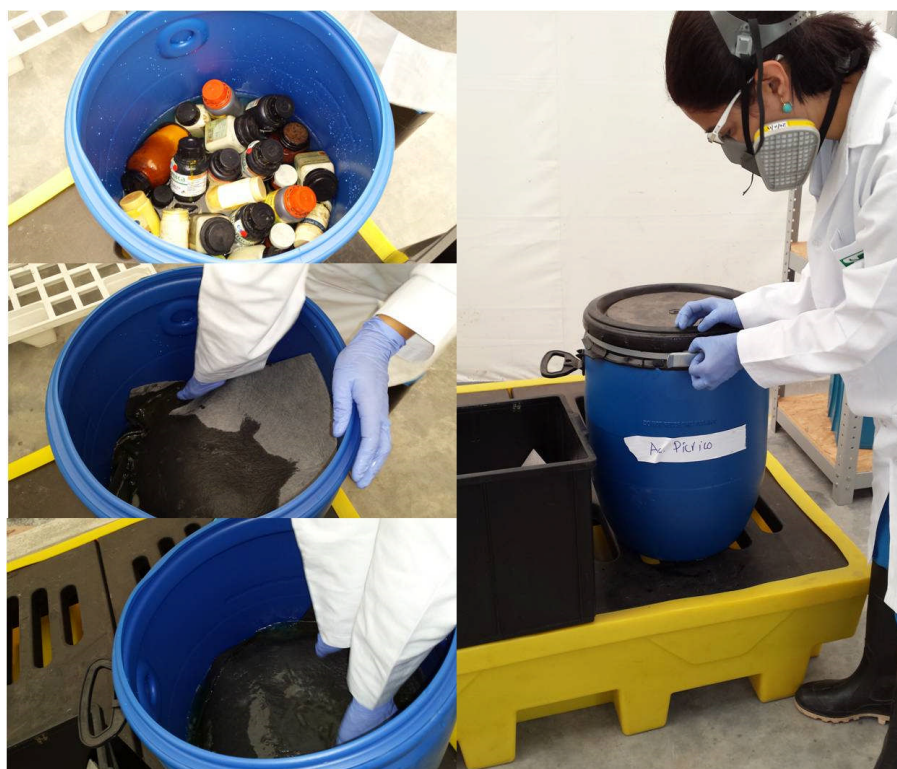
Figura 4. Acondicionamento especial do ácido pícrico com uso de manta absorvente para manter os frascos submersos.
