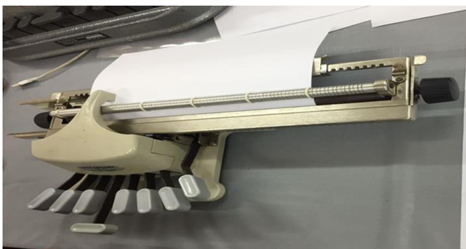
Máquina Tetrapoint utilizada para transcrever o braile
