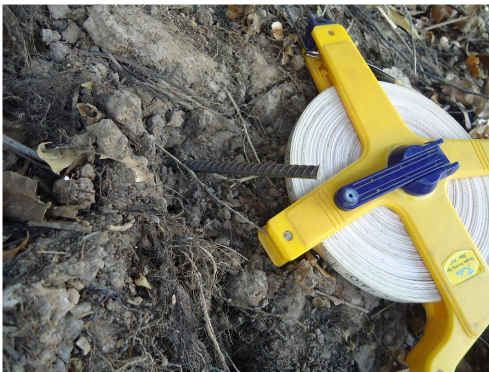
Figura 2: Instalação dos pinos na margem côncava
