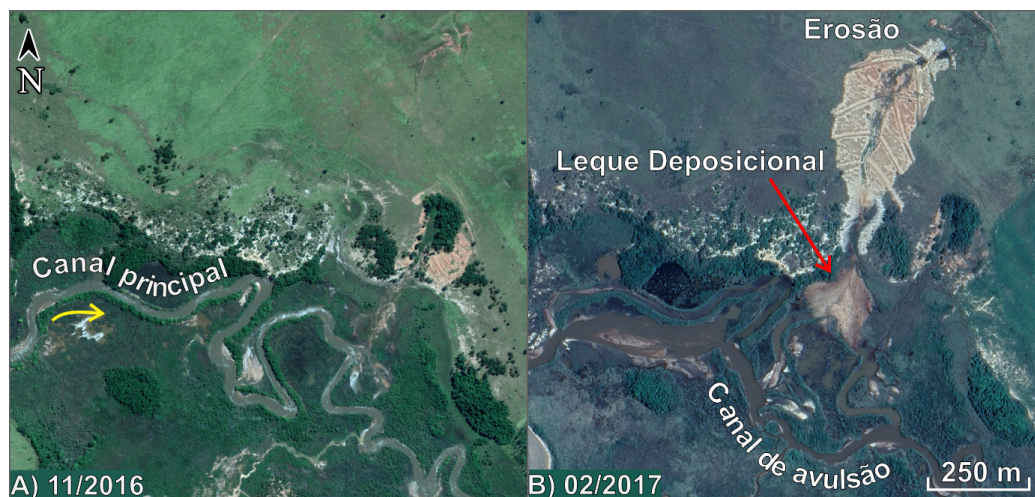
Figura 7. Processo de avulsão por anexação, resultante do bloqueio do canal principal. A) canal principal anterior a avulsão, B) bloqueio do canal com avulsão em decorrência do barramento com a formação do leque aluvial
