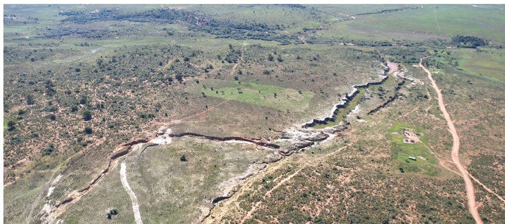
Figura 7. Processo de voçorocamento, impacto sobre os mananciais, TI Sete Cerros, município de Paranhos (MS)
