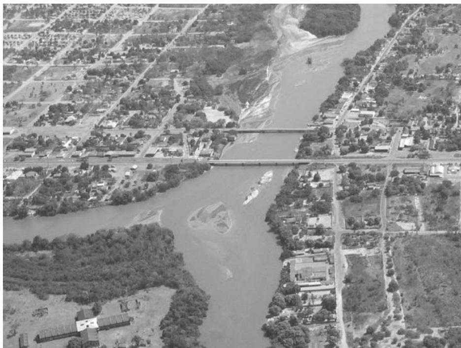
**Figura 3** - Cidade de Coxim MS. É possível observar nesta foto aérea, sedimentos depositados nos leitos dos rios Coxim (à esquerda) e Taquari, destacando-se os depósitos no ponto de confluência destes canais fluviais. São sedimentos provavelmente transportados do Planalto para a Planície contribuindo para o assoreamento desta parte do canal fluvial.
