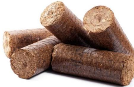
FIG. 10 – Briquetes provenientes da compactação de resíduos lignocelulósicos (figura adaptada)<sup>9</sup> .
