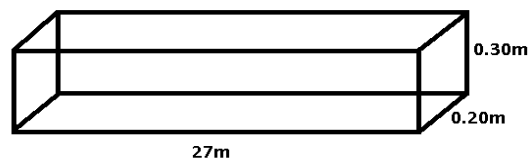
Figura 8 – Representação do cálculo do volume de concreto de uma viga.
