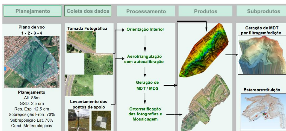
Figura 3: Síntese do processo de um projeto em aerofotogrametria com VANT's. Fonte: FRANÇA, 2018. Adaptado de: BAZAN, 2018.
