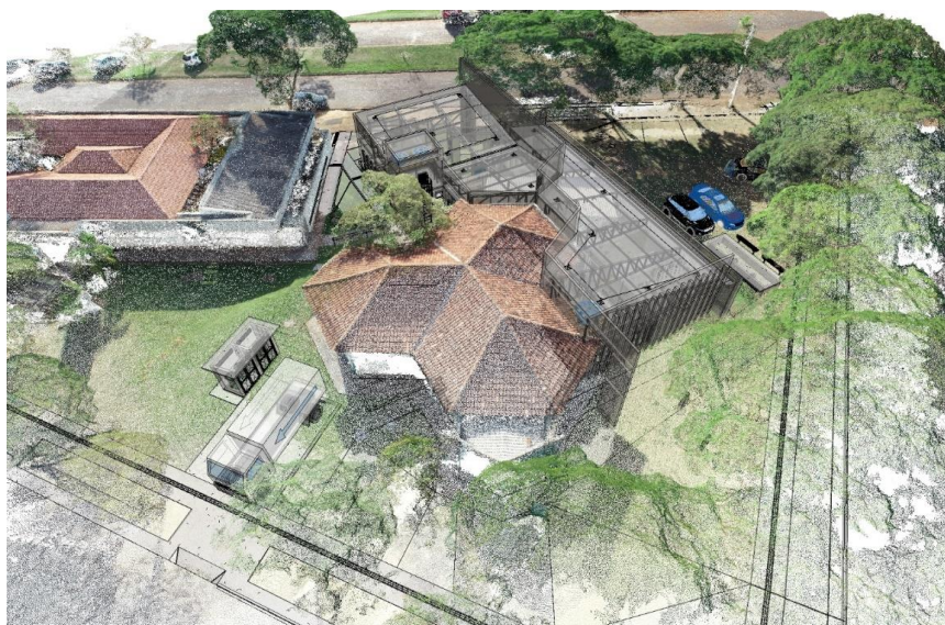
Figura 7: Nuvem de pontos com modelagem da estrutura ampliada. Fonte: Autores, 2019
